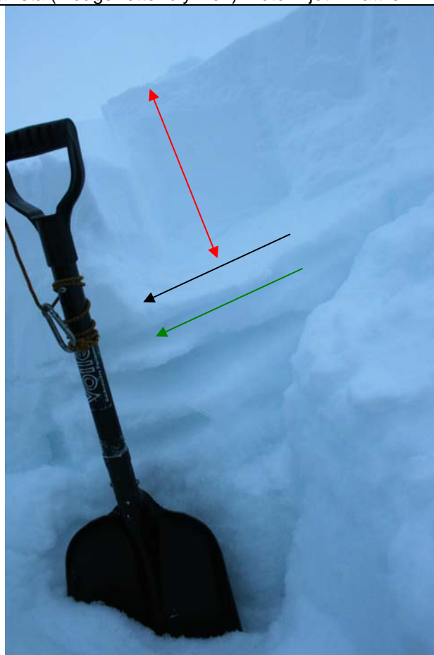
Lagdelingen i bruddkanten med 30 cm fokksnø (rød pil) over diverse harde lag med mellomliggende svake lag. Skredet løsnet under fokksnøen (svart pil), mens stabilitetstester 2 dager etter ulykken gav meget lette brudd ved grønn pil. Foto: Roar Saure Volda/Ørsta Røde Kors hjelpekorps.
